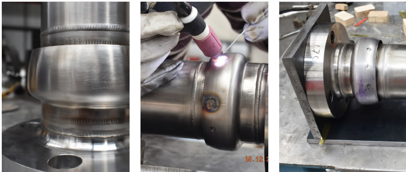
Soldadura Inconel para uniones articulables, General Electric Aviation, Querétaro, QRO.
